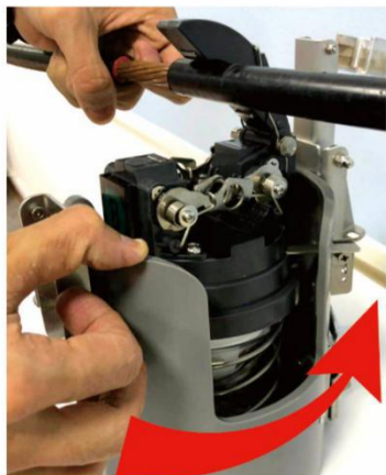
4. 继续下拉并旋转安装工具，使故障指示器的动板也脱离电缆；
