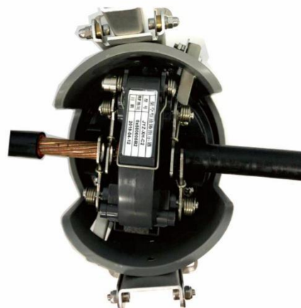
2. 手持绝缘杆把安装工具向上举起，如图让安装工具对准并包裹故障指示器，安装工具内两边卡扣自然卡住故障指示器。
