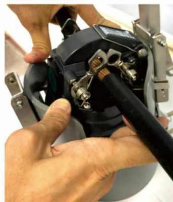
3. 向下拉绝缘杆，使故障指示器的四个电缆压线板松脱电缆；
